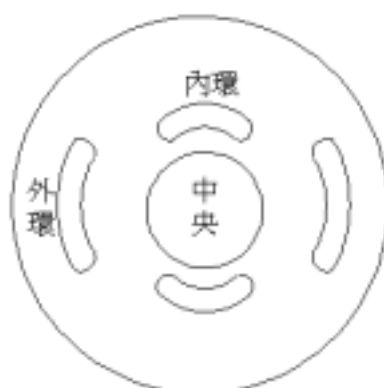
圖 2E-1 成功大學物理系大三光學實驗球面像差實驗遮光板之孔徑
